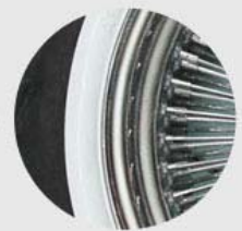
Окончательно накачайте шины. Между бортиком флипера и краем диска не должно быть зазора
