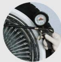
Частично надуваем шину. Внутренняя часть Флипера должна быть полностью под краем диска.
