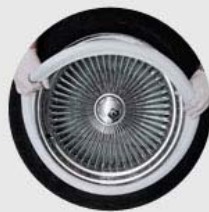
Заводим флиппер под диск, и размещаем его на покрышке под диском
